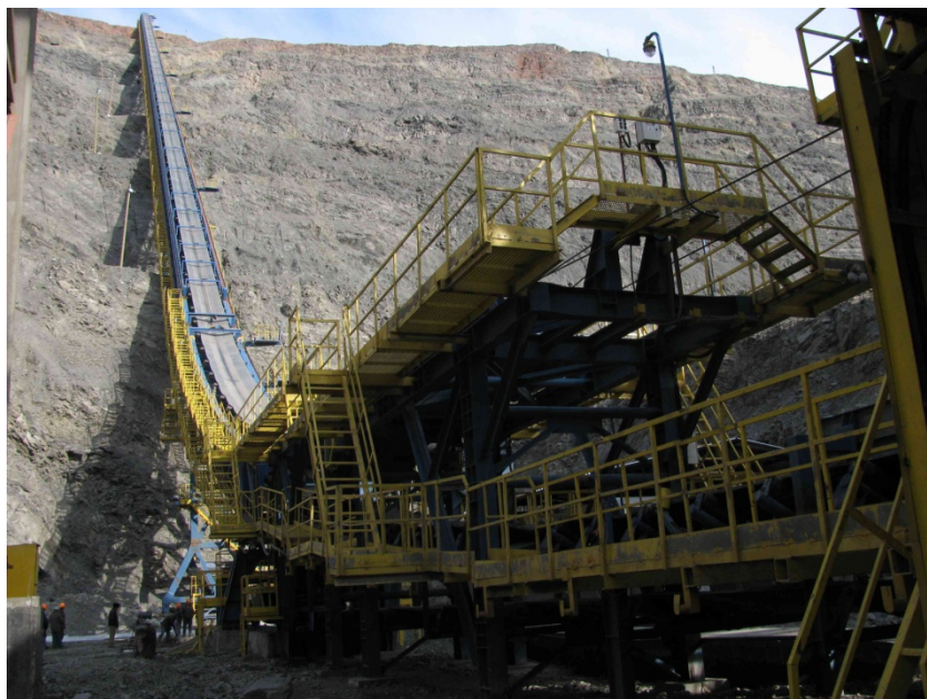
Рис. 2. Крутонаклонный конвейер комплекса ЦПТ-руда
